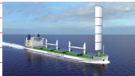
CO 2 排出量を大幅に削減する新デザインのばら積船
