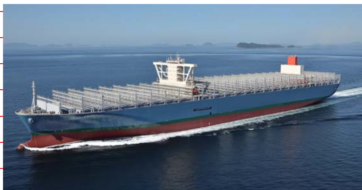
コンテナ船(長さ400m、2万個※の金属製の箱コンテナを一度に積みめす) 機械・食糧・雑貨など 世界中からさまざまな商品運びます。 ※長さ20フィートコンテナ(長さ約6m、幅2.4m、高さ2.6m)で換算した場合の個数。
