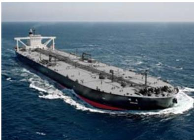
シリーズ船と違い、原油を積載するカーゴタンクすべてに蒸気加熱管を施工した点が挙げられます。原油の中には高粘度のものがあり、その高粘度原油を船内のポンプで積み出すためには、原油を加熱して粘度を低くする必要があります。通常の VLCC ではカーゴタンクに加熱管を設けることはしませんが、高粘度原油にも対応できるようにするため、各カーゴタンクに蒸気を通す蒸気管を施工したものです。
