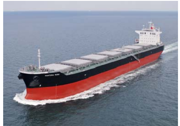
パナマックスバルカー「PANTERA ROSA」主要目 全長 × 幅 × 深さ: 225.0 m × 32.24 m × 19.90 m 載荷重量: 78,844 DWT、最大搭載人員: 25 名 船級: 日本海事協会(NK)、船級: パナマ
