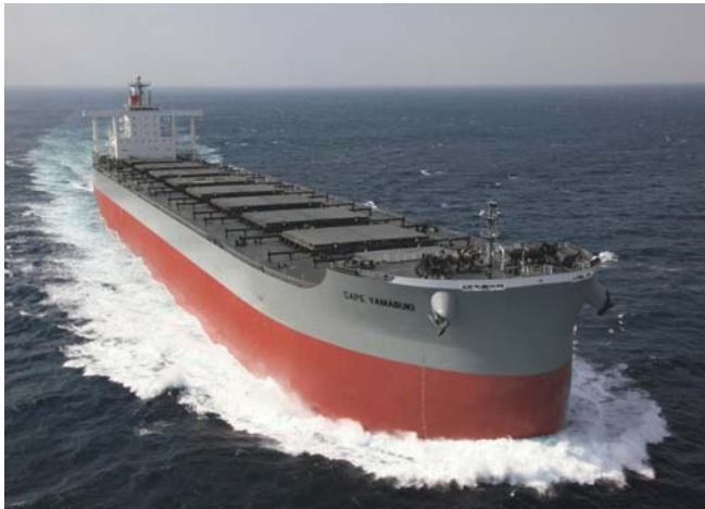
180,000 重量トン型ばら積み運搬船「CAPE YAMABUKI」主要目 全長(垂線間) × 幅 × 深さ: 292.00(288.00) m × 45.00 m × 24.70 m 夏期満載喫水: 18.20 m、総トン数: 92,977 GT、載貨重量: 182,534 DWT 主機関: 川崎-MAN B&W 6S70MC-C MK7 × 1 基 (連続最大出力 17,780 kW × 87 回転/分) 航海速力: 約 15.3 ノット、定員: 28 名、船級: 日本海事協会(NK)、船籍: 日本(神戸)
