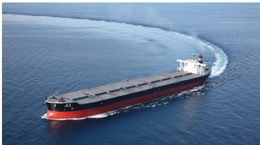
「BAO FU」(宝富)主要目 全長 × 幅 × 深さ: 329.95 m × 57.0 m × 25.10 m 夏季満載喫水: 18.0 m、総トン数: 132,537 GT、載貨重量: 250,877 DWT 主機関: 三井-MAN B&W 7S80MC-C 型ディーゼル機関 × 1 基 (連続最大出力 21,910 kW × 74.5 回転/分) 航海速力: 15.0 ノット、船級: 日本海事協会(NK)
