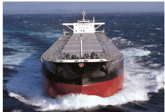
ばら積み貨物運搬船「ノルド ハーキュレス」主要目 全長(垂線間長) × 幅 × 深さ: 240.00(233.00) m × 43.00 m × 20.70 m 総トン数: 60,997 GT、載貨重量: 110,944 DWT 主機関: 三井-MAN B&W ディーゼル機関 6S60MC-C × 1 基 (連続最大出力 13,560 kW × 105.0 回転/分) 航海速力: 14.5 ノット、最大搭載人数: 25 人、船級: 日本海事協会(NK)、船籍: パナマ
