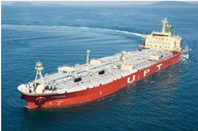
本船は、当社が開発したMR(Medium Range)タンカーの第4世代にあたり、呼称「Mark-IV」として2008年から開発・設計したタンカーです。Mark-IVの特徴としては、第3世代にあたるMark-III(D/W 50,000 MT プロダクトタンカー)の4つのコンセプト(①オペレーション、②安全、③メンテナンス、④環境)を伝承すると同時に、より多くの顧客に満足して頂けるようにIMO Type2に相当するケミカル製品も積載することが可能なケミカル兼プロダクトタンカーとしている事です。
