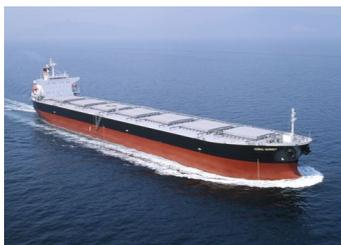
イドローリング方式を採用し、油圧モーターによるチェーンドライブで開閉できるようになっており、主機関には低速・ロングストローク型 2 サイクルディーゼルエンジン 1 基を装備し、高効率・大直径プロペラを採用して一層の低燃費を
