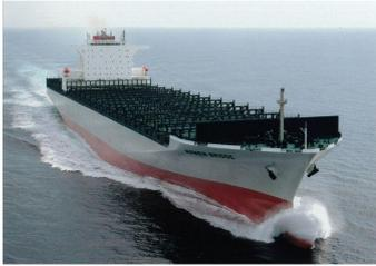
コンテナ積載ホール内にはセルガイド、甲板にはラッシングブリッジを装備しており、20 フィートコンテナ換算で最大 8,212 個の積載能力を有しています。
