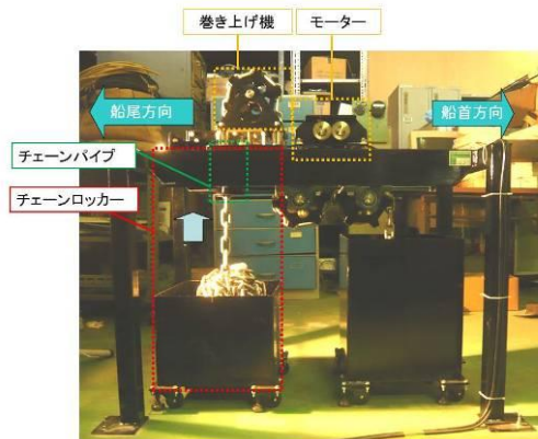
【投錨時のアンカーチェーン挙動を再現するための模型試験機】
