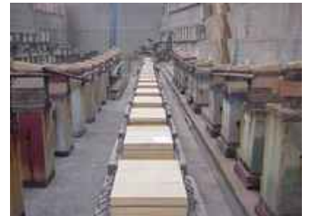
(写真 2) 盤木配置を後方から見る
