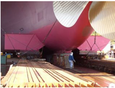
(上)無事進水した "KOTA PURI" (左)"KOTA PURI" の船尾に付けられた進水抵抗板
