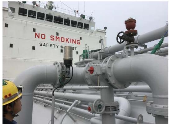
【写真 2: 回路を短絡させることで疑似的に海水流量低下の状態を作り、警報が鳴ることを確認する検査】
