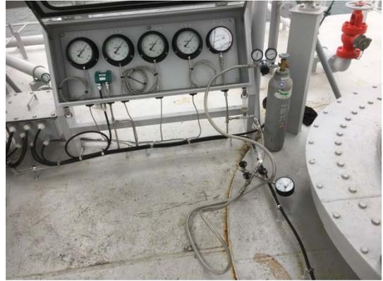
【写真 1: 圧力計にポンペを繋いで強制的に圧力を上げることで、高圧警報が鳴ることを確認する検査】
