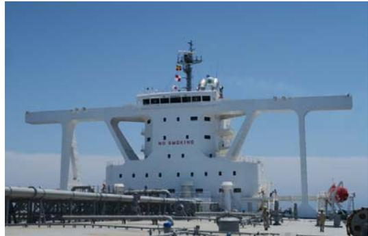
【本船に採用した風圧力低減型居住区】
