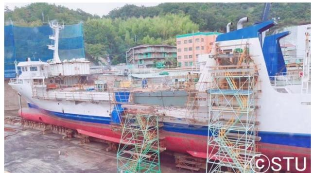
【上部構造物が撤去された STU48号】
