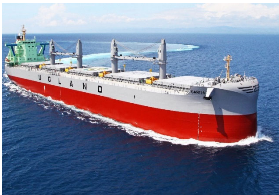
【TESS シリーズ累計 500 隻目となる TESS64 AEROLINE の本船。丸みを帯びた流線形状船首が特徴】
