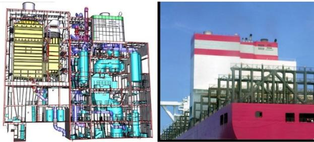
【14,000TEU コンテナ船スクラパー船内配置(左)と完成時外観(右)】
