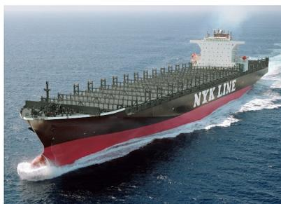
速力に合わせて最適となる船型を採用しています。また、常に構造様式、船型性能の改善も続けており、その結果、約 10 年前に建造されたコンテナ船に比べ約 25% の燃費削減が達成されています。
