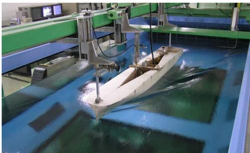
当社では水位調整装置により 0.1 リットル単位で水量を自動調整することで定在波を最小化しています。その他の特徴として縦型の抵抗試験機を採用することにより水槽水面の半分をオープンスペースとし、波形をサーボ式波高計で計測可能としています。
