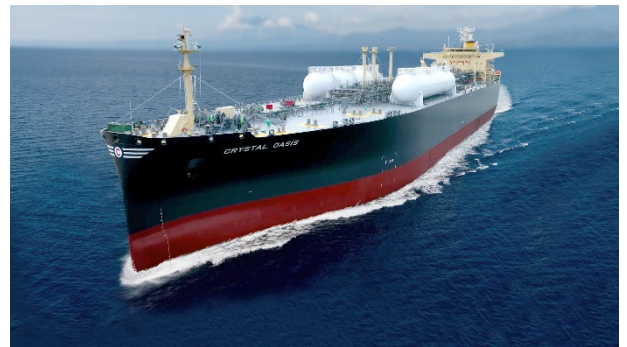
【LPG 燃料推進 LPG 運搬船「CRISTAL OASIS」】
