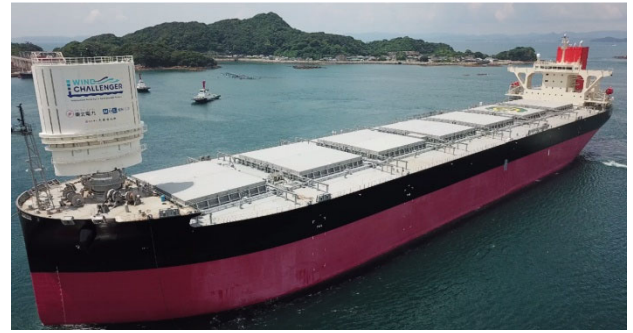
【硬翼帆を搭載した 99,000トン型ばら積み貨物船】
