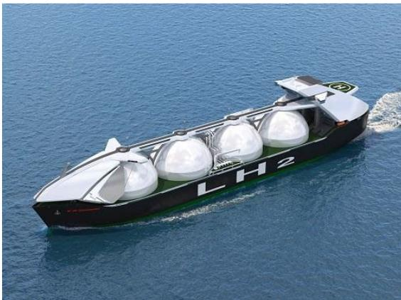
【160,000m<sup>3</sup>型 液化水素運搬船完成イメージ】
