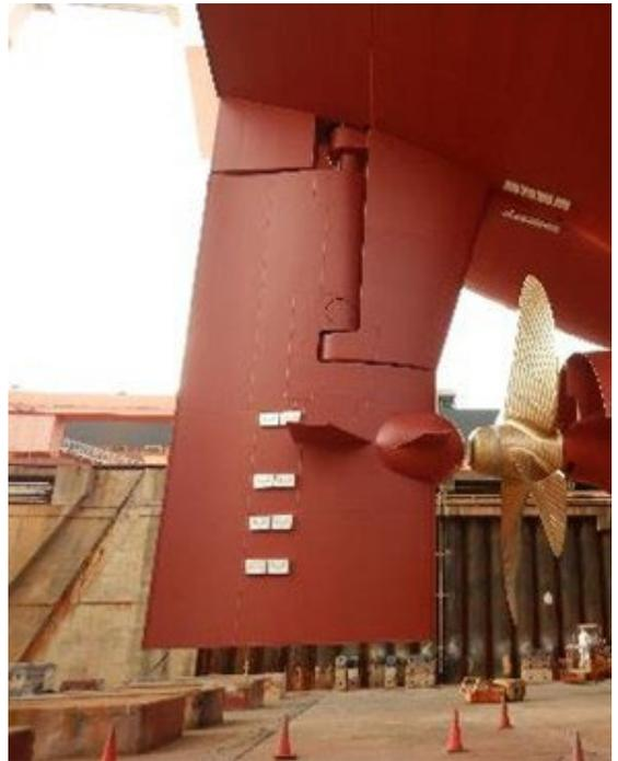
【Fig2 舵バルブフィンの実船搭載写真(左) 舵付近の流場解析CFD計算結果(右)】
